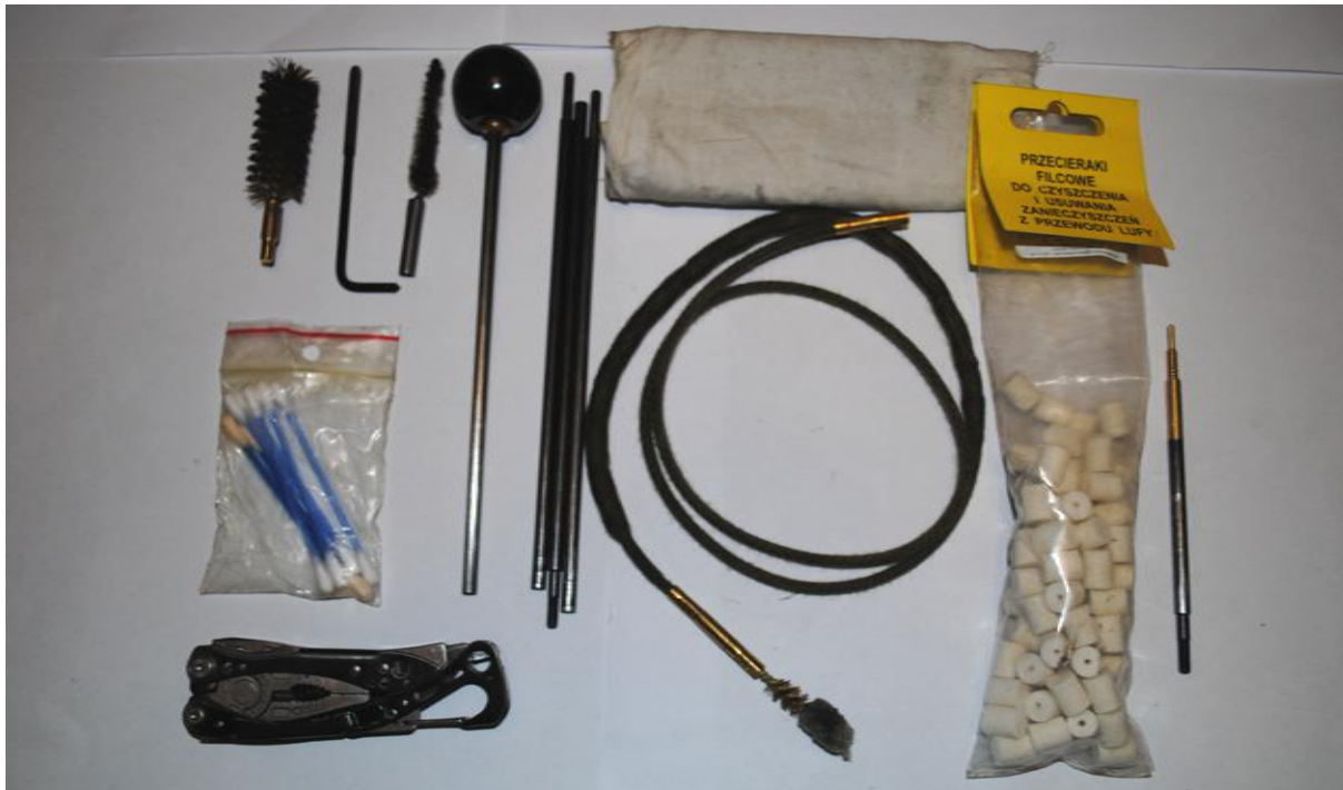
Rysunek 1 - Od prawej: adapter do przecieraków, przecieraki filcowe do kalibru 7,62mm, szmatka, wycior sznurowy firmy OTIS z przykręconą szczotką, skręcany wycior, szczotka do kal. 7,62mm, rozwiertak, szczotka do strzelby kal. 12, patyczki do uszu, moollitool
