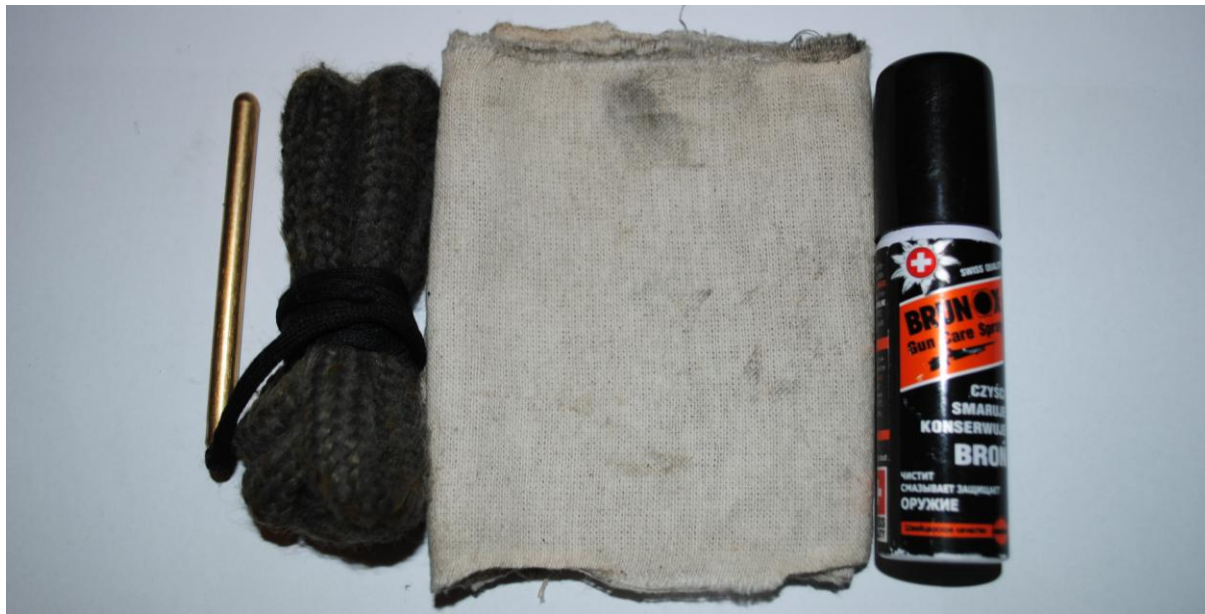
Rysunek 4 - Polowy zestaw do czyszczenia kbk AK: sznurek firmy Luszczyk, szmatka oraz Brunox 25ml
